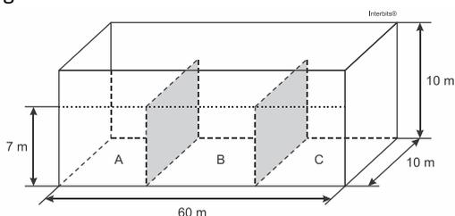
Suponha que ocorra um desastre quando o petroleiro se encontra com sua carga máxima: ele sofre um acidente que ocasiona um furo no fundo do compartimento C. Para fins de cálculo, considere desprezíveis as espessuras das placas divisórias.
